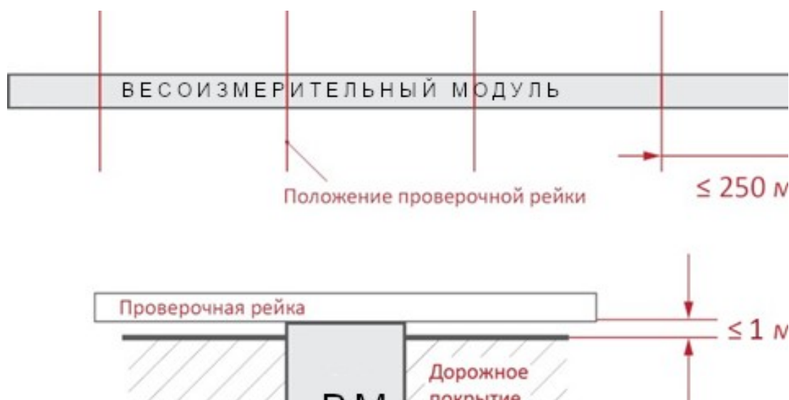
Рис. 45. Проверка неплоскостности сопряжения поверхности Весоизмерительного модуля и дорожного покрытия
